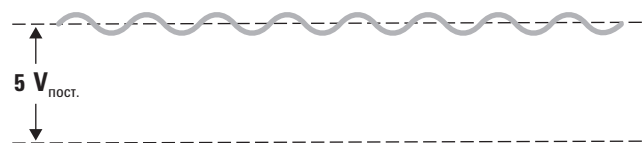
Рис. 4. Выходное напряжение источника питания постоянного тока содержит небольшие пульсации. Выходное напряжение источника можно охарактеризовать, измерив постоянную и переменную составляющие.
