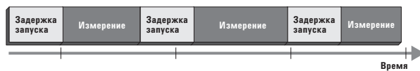
Рис. 7. Измерения, выполненные с задержкой запуска, причем на выполнение каждого измерения ушло разное время. Эта модель малоприспособна для дискретизации сигнала, поскольку время между измерениями варьируется.
