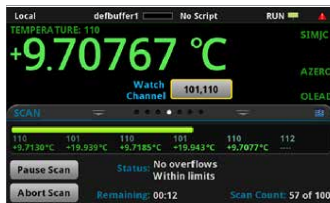
Быстрый и простой мониторинг состояния тестирования на экране системы DAQ6510.
