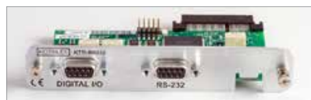
KTTI-RS232 – интерфейс RS-232 с 6 цифровыми портами ввода-вывода.
