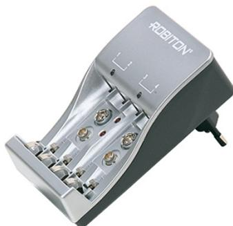
**ROBITON SMART S500/plus** заряжает 2 или 4 Ni-Cd и Ni-MH аккумулятора размера AA/HR6 и AAA/HR03 и 1-2шт. 9В аккумуляторов типа «крона». Микропроцессор отслеживает скачок напряжения  $\Delta V$  и, когда аккумулятор будет полностью заряжен, переключает режим заряда с быстрого на режим trickle charge (поддержание заряда малым током). При этом полностью заряженные аккумуляторы могут оставаться в устройстве с полной емкостью в течение длительного времени.
