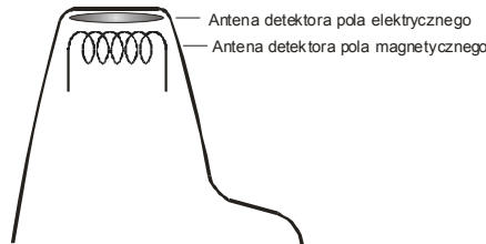
Рис.3 Размещение антенн детекторов в головке приемника
