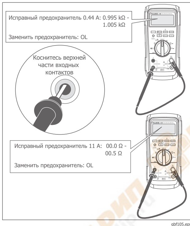
Figure 10. Проверка предохранителей
