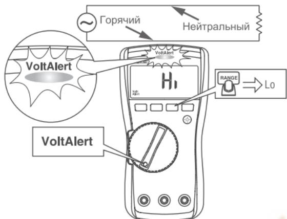
Чтобы обнаружить присутствие переменного напряжения, поднесите верхнюю часть Измерителя вплотную к проводнику. На обнаружение напряжения Измеритель указывает звуковым и визуальным
