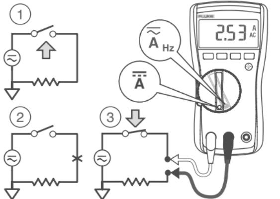
Отключите питание цепи, разомкните ее, подключите Измеритель параллельно цепи, а затем включите питание цепи.
