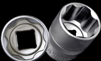
Головки SuperLock или Супер замок отличаются от шестигранных головок по месту захвата крепежа. Если шестигранный профиль головки максимальное усилие прикладывает к углам, то головки SuperLock нагружают грани (плоскость) крепежа.
