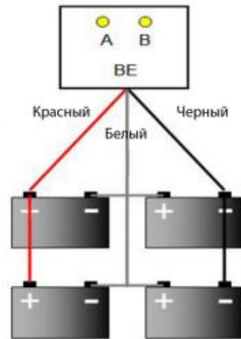
Массив из 4 аккумуляторов 24В
