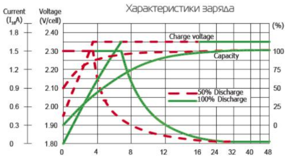
Рисунок 2 – Характеристик напряжения постоянного заряда
