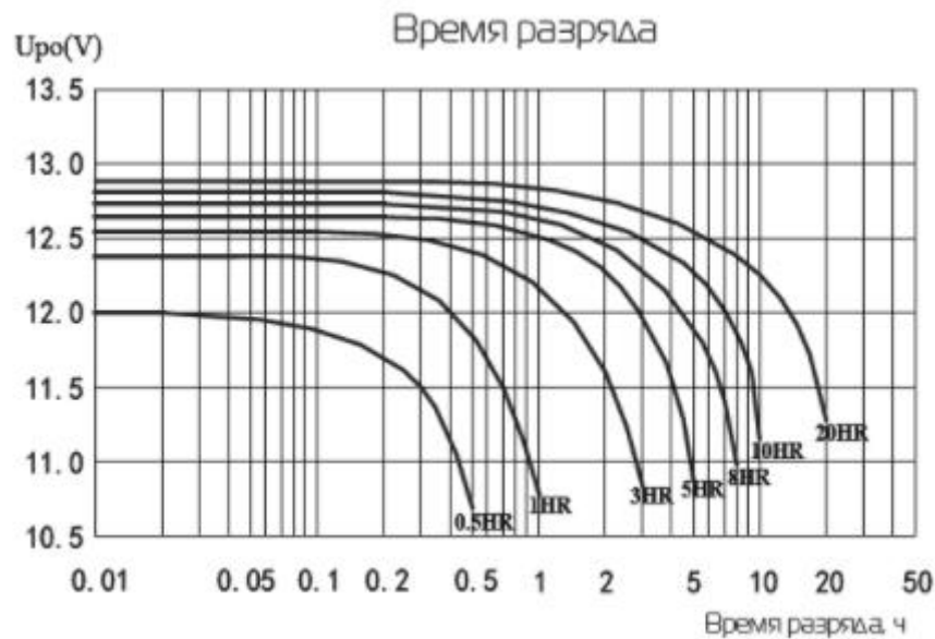
Рисунок 1 – Производительности разряда при различной скорости разряда
