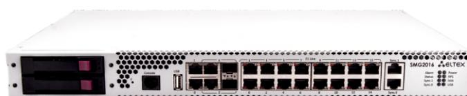
**Гибридная платформа SMG-2016** может использоваться в качестве транкового шлюза для сопряжения сигнальных и медиапотоков TDM и VoIP-сетей, IP-АТС с поддержкой функций ДВО и СОРМ, а также выступать универсальным решением для построения инфокоммуникационных сетей связи нового поколения. Широкая функциональность, строгое соответствие стандартам и высокая надёжность операторского класса позволяют решать на базе SMG-2016 большинство возникающих у операторов и сервис-провайдеров задач.
